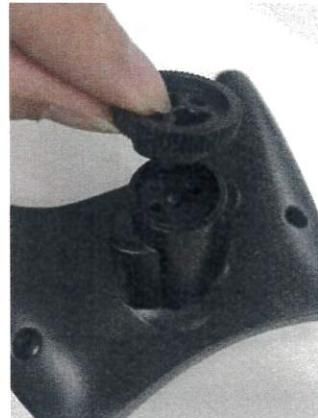
3. 分解したパーツの部品④をブラケット台座部にネジ穴を合わせて取り付けます。
