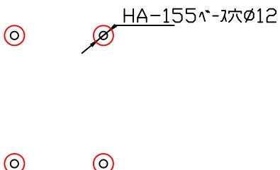
3 表壁面にもホールソーでボルト通し穴を大きめに開ける。
