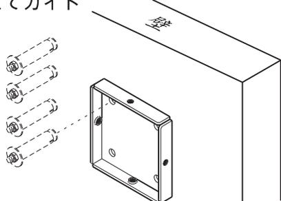
壁面にボルト・ネジで固定してください。壁面に取り付けるボルト・ネジは付属されていません。壁の状態に合わせてご準備ください。
