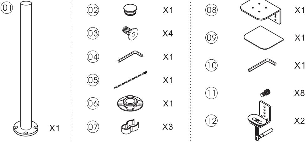
まずクランプを机に固定してください。それから03ネジで支柱を固定してください。
