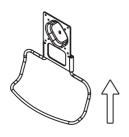
①VESAブラケットへ②ハンドルを左図のように奥まで差し込み、④六角レンチを使い ③取り付けビスで固定します。
