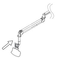
ステップ1にて組み立てたハンドルをHAロングアームへ取り付けます。 その際にはステップ2で取り外したナット、ワッシャーを使用してください。
