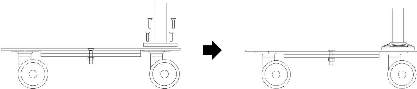
※最初は手でナットを支えながらボルトを締めます。
